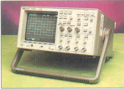
Bild 1. Aus der HP-5460x-Familie sind neben der 602-Version auch der 100-MHz-Zweikanaler 54 600 A (5274 DM plus MwSt.) sowie der 54 601 A (100 MHz, 2 + 2-Kanal, 6127 DM zuzüglich MwSt.) lieferbar.
